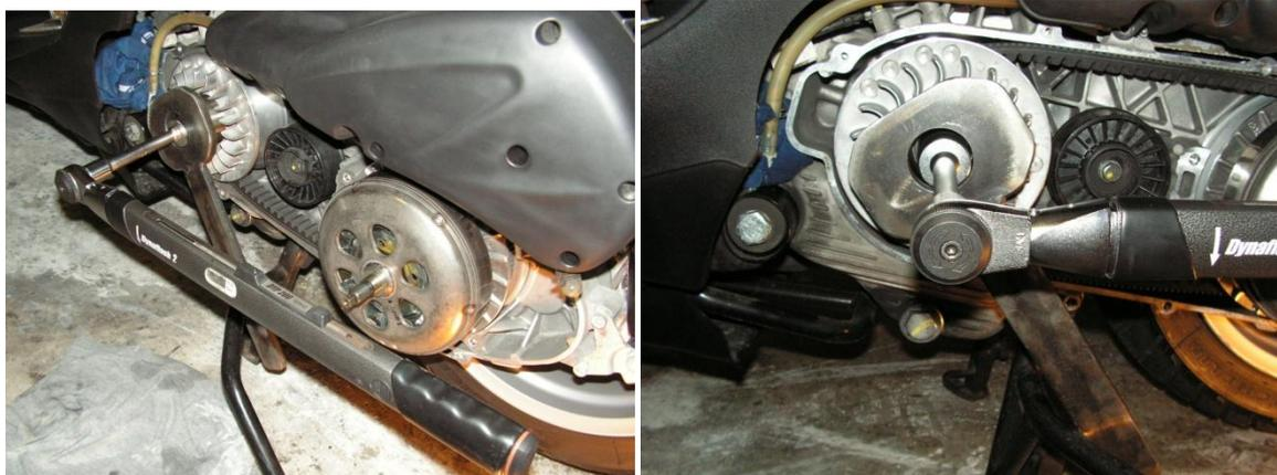
Reposer le couvercle et serrer les 4 vis M8 n° 6 et 7 et les serrer à un couple de 23 à 26 Nm . Visser et serrer les 7 vis M6 n°5 à un couple de 11 à 13 Nm. Reposer le carter gris et serrer les 4 vis n°1.
