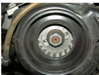
Reposer la petite puis la grande rondelle sur l'arbre d'entraînement, mettre un peu de graisse graphitée sur le filetage, visser l'écrou de 21 n°4. Placer la clé déportée de 21 de façon à ce qu'elle soit bloquée sur la béquille , prendre une douille de 10 et une clé dynamo . Attention il faut serrer dans le sens inverse des aiguilles d'une montre, donc il faut faire attention au sens de la clé dynamo (voir la flèche sur la clé). Serrer à un couple de 92 à 100 Nm.
