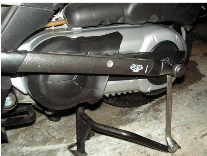
Remettre le bouchon plastique et serrer la vis n°2.
